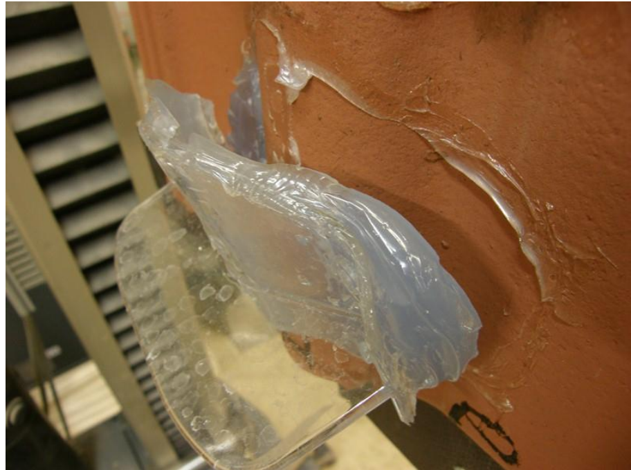
Kulo 1 irronnut täysin tiilestä voimalla 3846N
